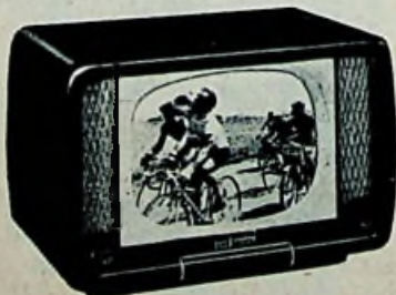
Telemaster van C.D.T. voor twee defuncties (819 en 625) (en de Tour de France)
